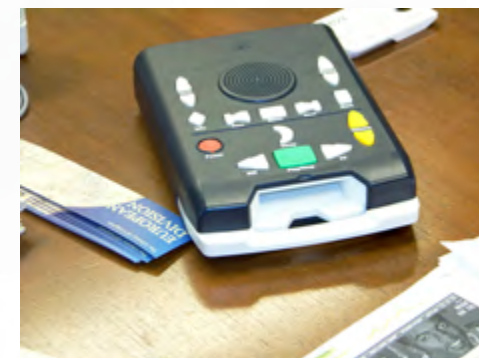
Urządzenie do odtwarzania audiobooków zapisanych na kasecie z pamięcią flash – zasoby Biblioteki Kongresu w Waszyngtonie
