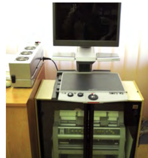
Na zdjęciu zaprezentowano dwa urządzenia: powiększalnik telewizyjny (na górze) oraz drukarkę brajlowską (na dole). Po lewej stronie widoczny jest również fragment wygrzewarki służącej do tłoczenia wypukłych rysunków.
