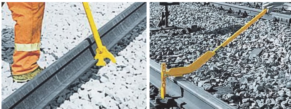
Rys. 4. Drażek do kantowania szyn (a) i dźwignia do podkładów(b)
