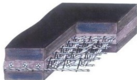
taśma z rdzeniem z linek stalowych z przekładką ochronną
