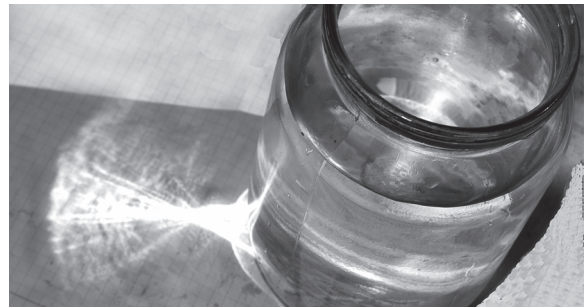
Фото 4. Збирання променів світла банкою з водою
